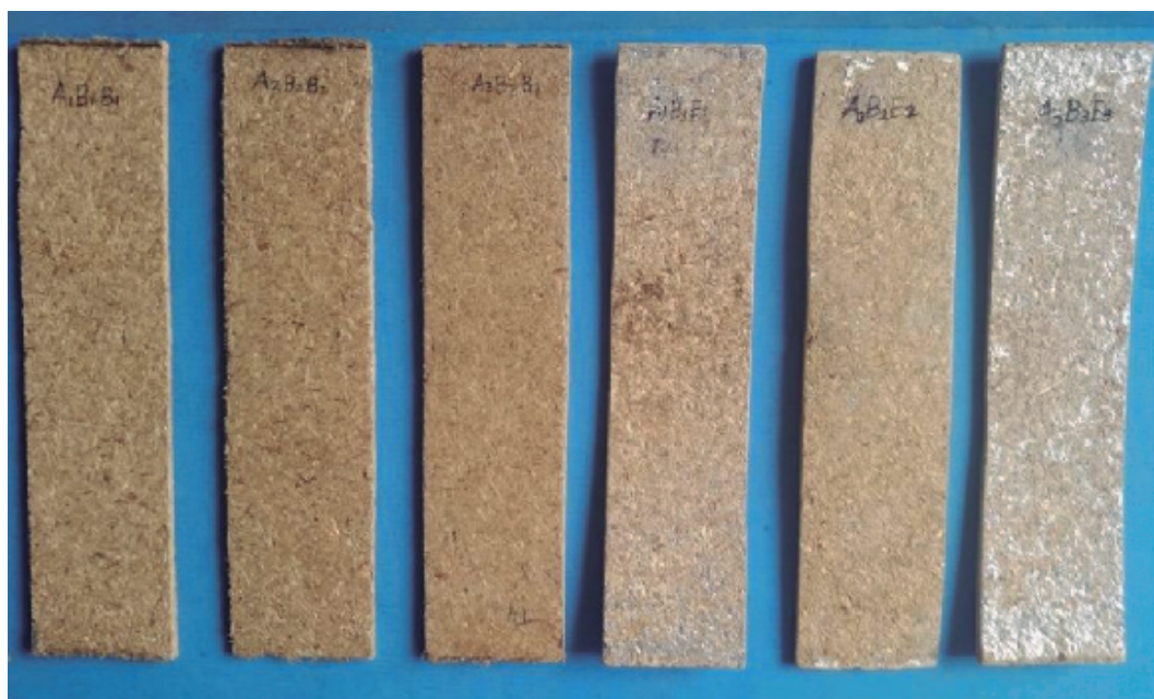
Figura 4. Prototipos de tableros aglomerados obtenidos para las diferentes mezclas empleadas estudiadas.
